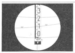
Senkrechte **Tachymeter-Kurzlatte** GVL1, mit erhöhter Ablesegenauigkeit zur optischen Distanzmessung (bis ca. 70 m). Aufstellung mit Lattenstativ oder Lattenträger im Dreifuß (Zwangszentrierung)
