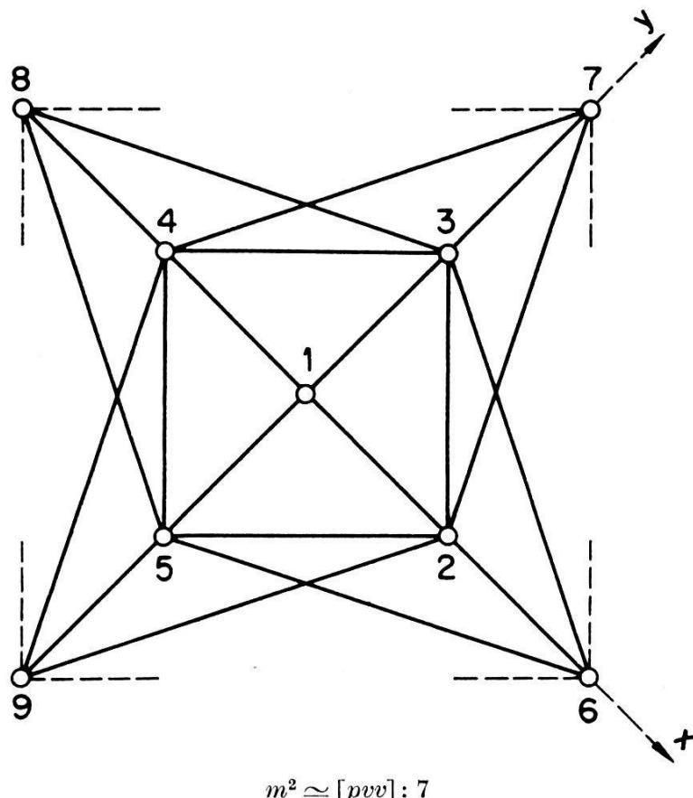
Avant d'inverser la matrice, on pressent que pour le nœud 1 l'ellipsoïde sera aplati. Le calcul est le même que pour la coupole. Des éléments fournis par calcul électronique on déduit que les longueurs des axes principaux des ellipsoïdes de déformation sont proportionnelles à:
