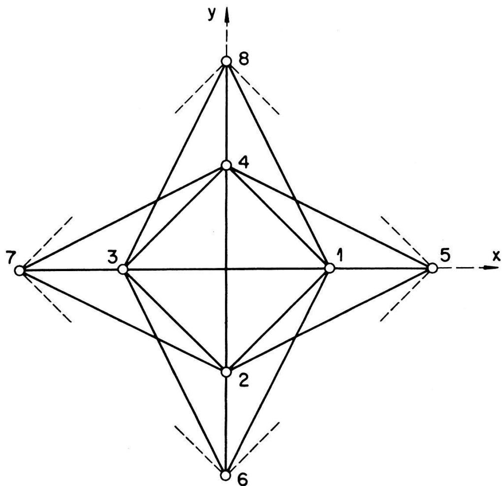
On déduit des éléments diagonaux et voisins de la diagonale les ellipsoïdes de déformation; les longueurs des axes principaux sont proportionnelles à  $\sqrt{0,339} = 0,582$ ;  $\sqrt{0,535} = 0,731$ ;  $\sqrt{0,935} = 0,967$  pour les nœuds 1 et 3 par exemple.
