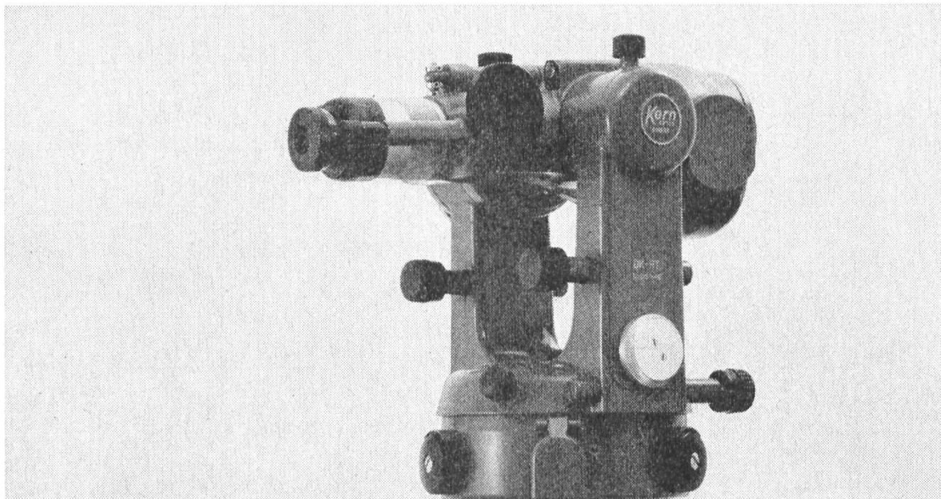
Kern DK-RT, das geeignete Instrument für Katastervermessung, Polygonierung und Absteckungsarbeiten hoher Genauigkeit
