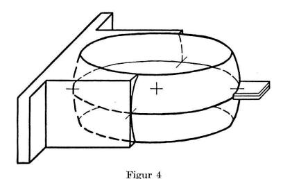
Das Befestigungsglied mit der inneren Kugelfläche für die  $\varkappa$ -,  $\varphi$ -,  $\omega$ -Drehungen der Kammer.
