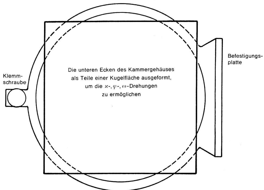
Figur 2 Die Kammer und das Befestigungsglied von oben gesehen
