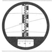
Fernrohrbild in Lage I mit Tachymeterlatte: Horizontale Distanz 21,5 m, Höhenunterschied + 2,06 m (Höhenwinkel 6,119) Vereinfachte Kreisablesung an einem festen Indexstrich, anstelle der Skala.
