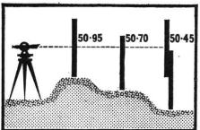
Die Selbstrechner-Latte zur Erleichterung von Erhebungsarbeiten
