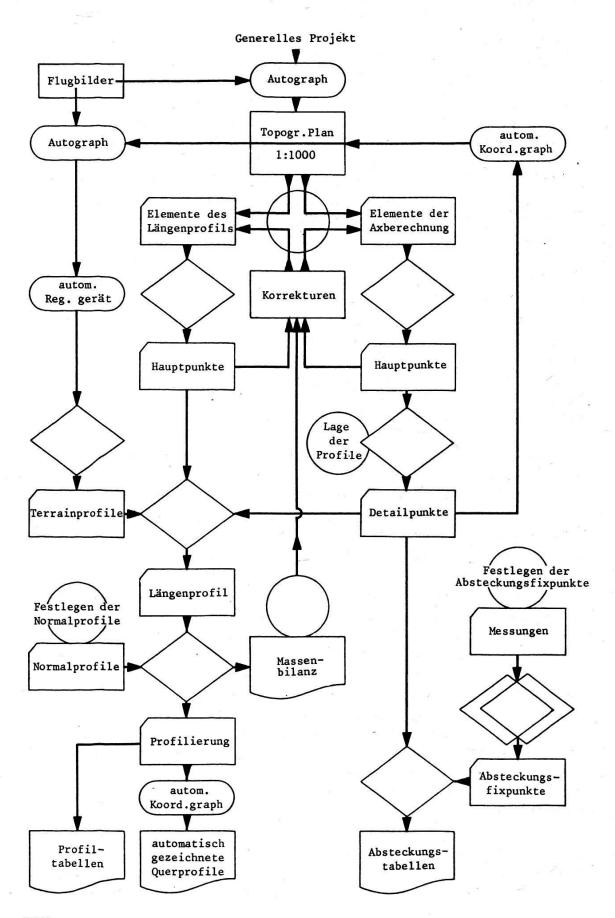
Es gibt Programme, welche anschließend an die Massenberechnung der Optimalisierung der Massentransporte dienen.
