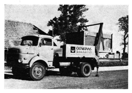
Abb. 3: Transportfahrzeug für Tondränrohre
