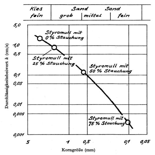
Bild 7: Kurve der Durchlässigkeitswerte k nach Darcy für reine Mineralböden ohne Tongehalt. In die Kurve sind die bei Zimmertemperatur ermittelten k-Werte für handelsübliches Styromull eingetragen. Danach entspricht Styromull unter Bodenlast hinsichtlich der Wasserdurchlässigkeit einem groben Sand
