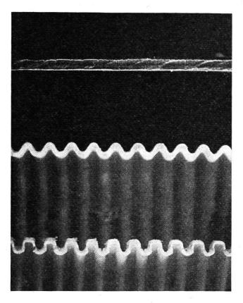
Bild 1: Wandprofile einiger handelsüblicher flexibler Dränrohre mit  $\varnothing$  50 mm (die Innenseiten der Rohre zeigen im Bild nach unten). Oben: Glattes Rohr aus Polyäthylen. Darunter: Gewellte PVC-Rohre mit unterschiedlicher Profilierung
