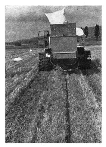
$Bild\ 5$ : Bodenschlitzgerät mit Styromull-Fülltrichter
