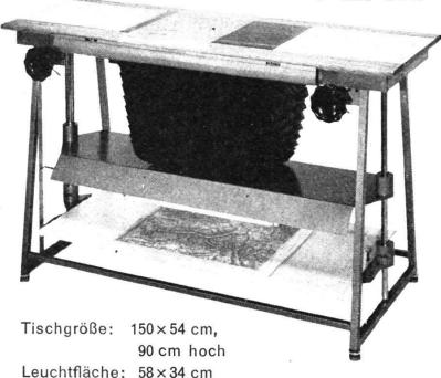
für zeichnerische Vergrößerung und Verkleinerung von Plänen und Karten mittels optischer Projektion bis 6fach. Einstellmöglichkeit zum Entzerren alter, verzogener Vorlagen. Für den Grundbuch- und Leitungskataster unentbehrliches Arbeitsgerät.
