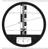
Fernrohrbild in Lage I mit Tachymeterlatte: Horizontale Distanz 21,5 m, Höhenunterschied + 2,06 m (Höhenwinkel 6,11<sup>9</sup>) Vereinfachte Kreisablesung an einem festen Indexstrich, anstelle der Skala.
