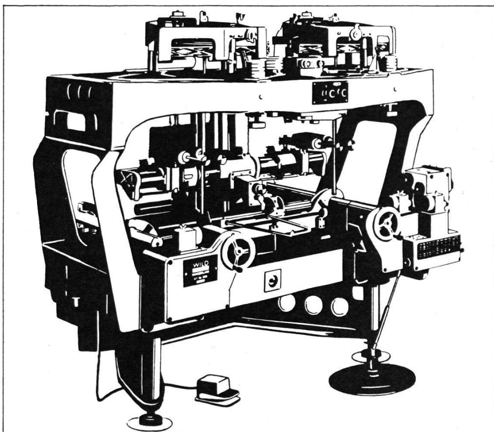
Der **Autograph Wild A7** ist ein Universalgerät 1. Ordnung für Aerotriangulationen und Kartierungen in allen Massstabren aus Luftbildern und terrestrischen Aufnahmen bis zum Format 23 cm x 23 cm (9" x 9") und mit einem Bildweitenbereich von 98 bis 215 mm. Elektrische Koordinatenregistrierung mit dem Wild EK5
