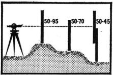
Die Selbstrechner-Latte zur Erleichterung von Erhebungsarbeiten
