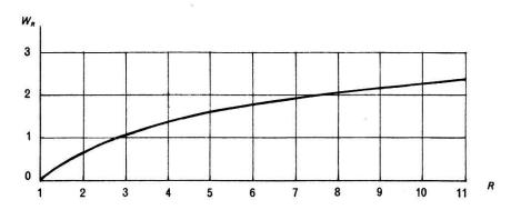
Bild 4: Logarithmische Verteilung des Radialwiderstandes
