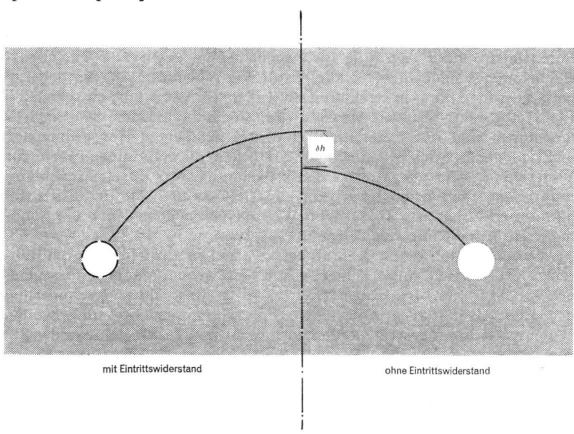
Bild 20: Absenkung des Grundwasserspiegels (nach Boumans)
