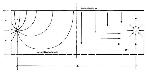
Bild 2: Zerlegung der Zuströmung in Komponenten; Skizze
