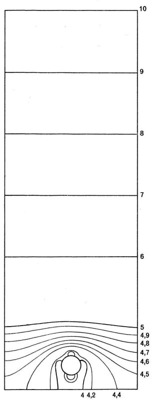
Bild 19: Potentialverteilung bei Zuströmung zu einem Rohr mit 4 Schlitzreihen bei der äußeren Randbedingung eines Drainagegrabens. Die Zahlen geben Potentialwerte an (Bodenoberfläche bei 10)
