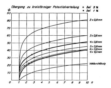
Bild 7: Potentialverteilung entlang Strahl durch Schlitzmitte bei verschiedenen Schlitzkombinationen (b auf  $R_0 = 2.5$  bezogen)
