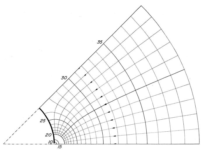
Bild 5: Strömungsbild zu einem Schlitz
