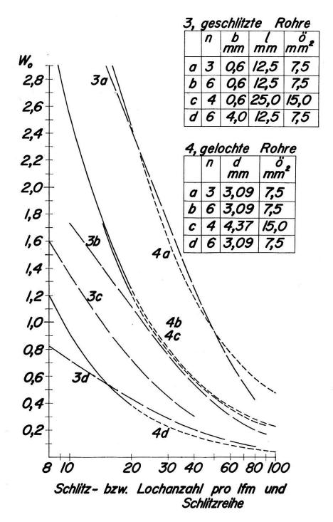
Bild 11:  $W_0$ -Werte von geschlitzten Rohren (gemessen) und gelochten Rohren (gerechnet nach Engelund), alle NW 50, in Abhängigkeit von der Schlitz- beziehungsweise Locharzahl pro Laufmeter Rohr und Schlitz- beziehungsweise Lochreihe
