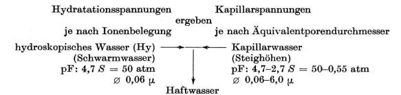
Theoretische Wasserkapazität (WK) eines Bodens, annähernd gleich dem Bereich des trägbeweglichen Bodenwassers nach Sekera sowie den Fein- und Mittelporenbereich nach Richard.
