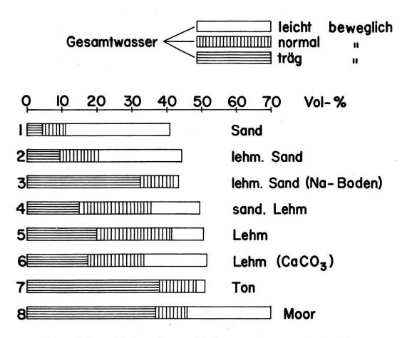
Abb. 5: Wasserbindung in verschiedenen Bodenarten (nach Sekera)
