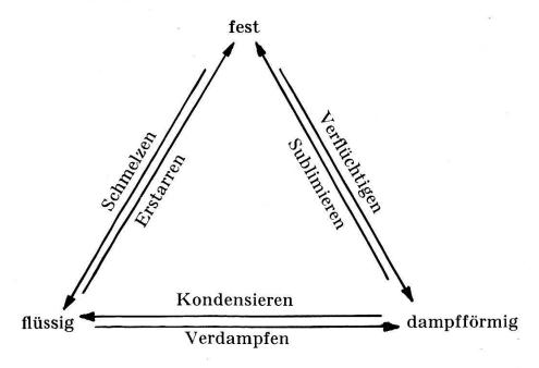
Die Moleküle der festen Stoffe befinden sich innerhalb eines Kristallgitters in Gleichgewichtslage. Durch Wärme-, also Energiezufuhr geraten
