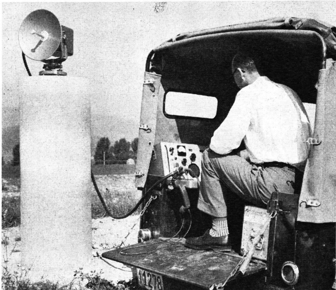
Der Wild DI 50 Distomat ist ein automatisches elektronisches Distanzmessgerät, das mit 3 cm-Trägerwellen arbeitet. Sein grosser Vorteil liegt in der Trennung von Mess- und Antennenteil, die, durch ein Kabel verbunden, bis zu 30 m voneinander aufgestellt werden können. Der Messteil kann daher im Fahrzeug oder an einem geschützten Standort bedient werden, während der Antennenteil auf einem Stativ, Gerüst oder Turm über dem Messpunkt steht.
