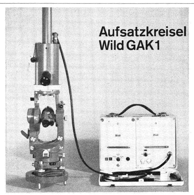
Der Aufsatzkreisel Wild GAK1 (System Rellensmann), ein praktisches, leichtes Zusatzgerät für den Theodolit, erlaubt absolute Richtungsbestimmungen nach Geographisch Nord unter fast allen Bedingungen in einem Temperaturbereich von -30°C bis +50°C. Zur Nordbestimmung setzt man den GAK1 einfach in die auf dem Theodolit montierte Kreiselbrücke (Zwangszentrierung) und erhält innerhalb 20 Minuten (einschliesslich Theodolitaufstellung) Geographisch Nord auf  $\pm$  30" ( $\pm$  1°).
