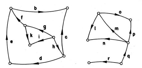
Man sagt, daß eine Anzahl Zyklen unabhängig sind, wenn die zugehörigen Zyklusvektoren linear unabhängig sind. In unserem vereinfachten Beispiel bedeutet dies, daß keiner der Vektoren der betrachteten Zyklen durch vektorielle Addition oder Subtraktion aus den übrigen hergeleitet werden kann. Zyklen 2, 3 und 6 sind zum Beispiel nicht unabhängig, da Zyklusvektor 6 durch Subtraktion des Vektors 2 vom Vektor 3 entsteht. Hingegen sind die Zyklen 2, 5, 6, 8 und 9 oder 1, 2, 6, 7 und 9 unabhängig.
