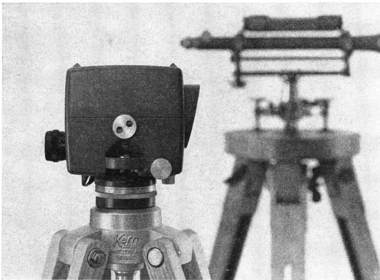
Mit dem Kern GK 1-A geht die Arbeit rascher voran, denn es besitzt nur noch zwei Bedienungsknöpfe: Fokussiertrieb und Seitenfeinstellschraube. Vergessen ist das langwierige Horizontieren mit den drei Fußschrauben, vorbei das Einspielen der Fernrohrlibelle vor jeder Messung. Kern-Automatik und Kern-Gelenkkopfstativ: die ideale Kombination für einfachere und schnellere Arbeitsweise.
