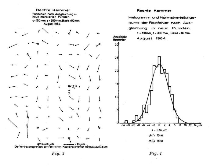
Fig. 3: Graphische Darstellung der Restfehler der Projektorkoordinaten nach Korrektion der regelmäßigen Fehler. Gewisse Korrelationserscheinungen sind offenbar
