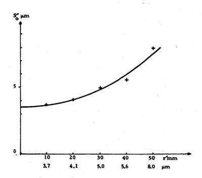
Fig. 7: Zusammenstellung der quadratischen Mittelwerte von mittleren Gewichtseinheitsfehlern der Bildkoordinaten in 5 Nahaufnahmekammern. 7 unabhängige partielle Kalibrierungen. Offenbar ist eine ausgesprochene Gewichtsvariation der Bildkoordinaten mit dem Radius vorhanden. Die Gewichte können als umgekehrt proportional zu den Quadraten der mittleren Gewichtseinheitsfehler berechnet werden
