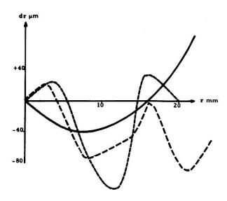
Fig. 9: Radiale Verzeichnung des Systems Abb. 8 (gemäß Torlegård). Voll gezogene Linie: Die Verzeichnung der Polaroidkammer; gestrichelt: Polaroid + Vidicon + Monitor; dicht gestrichelt: die Verzeichnung des ganzen Systems
