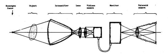
Fig. 8: Abbildungsprinzipien eines Röntgen-Televisionssystems für medizinische Zwecke. Das System ist partiell kalibriert worden. Vgl. Fig. 9
