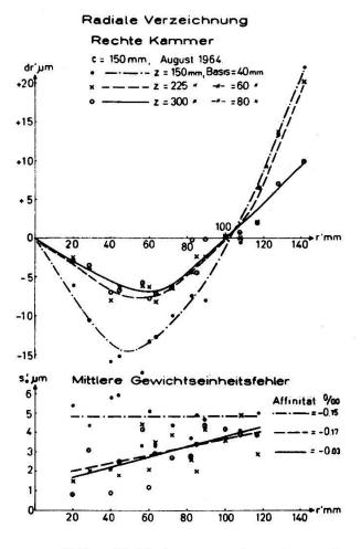
Fig. 2: Resultate von partiellen Kalibrierungen eines Auswertegerätes mit mechanischer Projektion. Die ausgeprägte radiale Verzeichnung variiert mit dem Projektionsabstand. Die mittleren Gewichtseinheitsfehler sind als klein zu bezeichnen. Die linke Kammer zeigte fast genau dieselben Resultate. Das Gerät wurde später umkonstruiert. Alle untersuchten Auswertegeräte mit mechanischer Projektion zeigten eine gewisse radiale Verzeichnung, die wahrscheinlich mit Deformationen zusammenhängt
