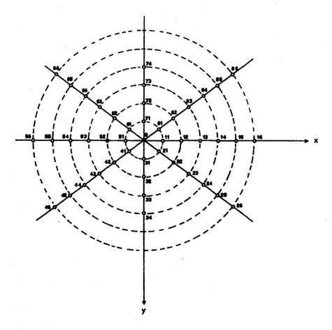
Fig. 5: Probefeld an einer Wand für partielle Kalibrierungen von Nahaufnahmekammern. Die Dimensionen des Feldes sind rund  $5,5 \times 3,5$  m. Die Koordinaten der Punkte sind mit einem mittleren Fehler von 0,1 mm gegeben
