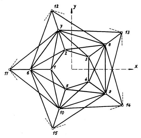
La figure ci-dessous montre une coupole Schwedler rendue aussi hyperstatique; mettons en évidence le rôle que peut jouer l'ingénieur-géomètre.
