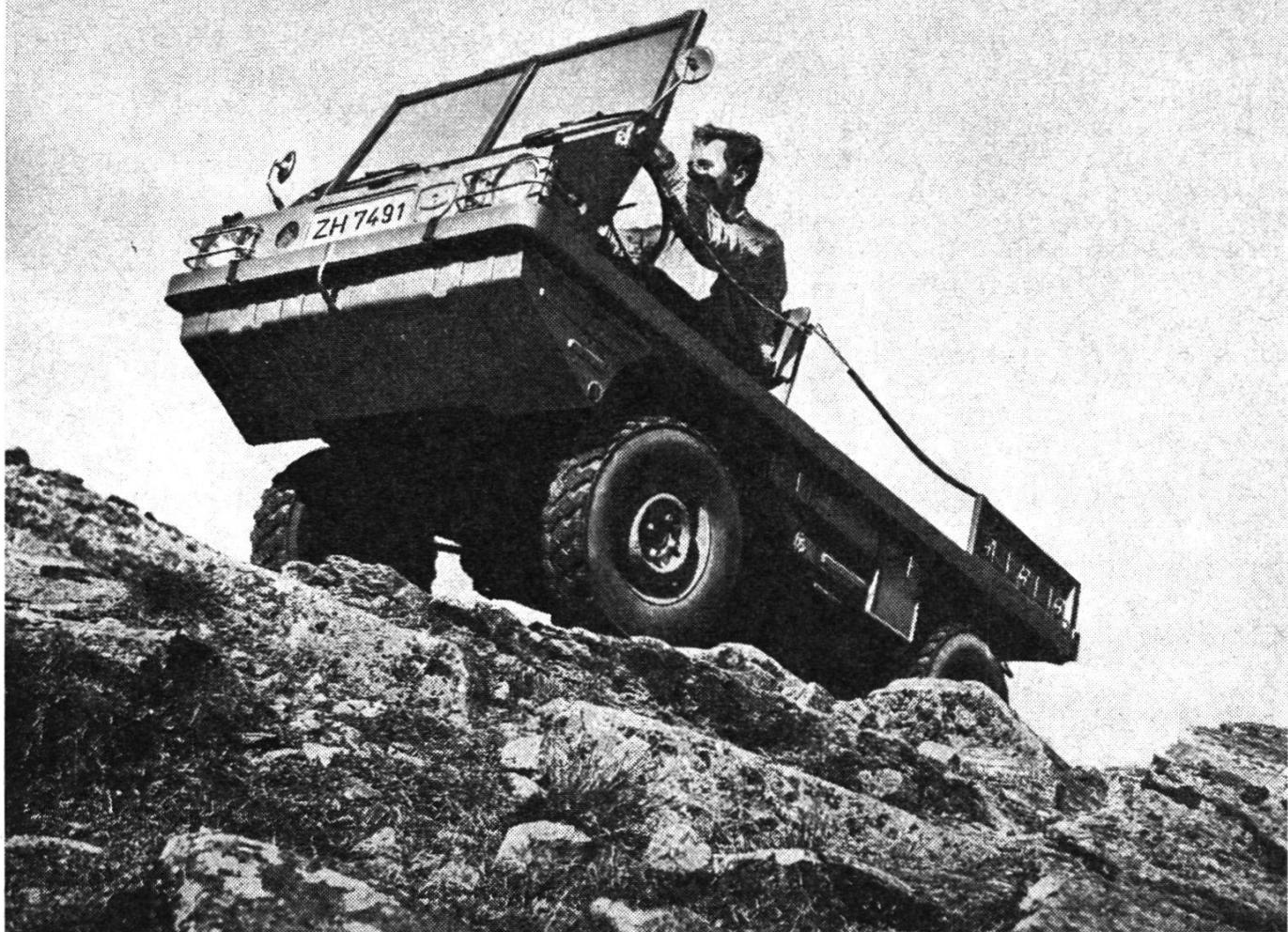
Als Gelände- oder Landwagen, mit oder ohne Verdeck, kann der STEYR-PUCH-HAFLINGER praktisch überall eingesetzt werden: Beim Bau, in der Landwirtschaft, als Feuerwehrwagen, zum Schneeräumen, zum Schleppen etc. Die Steigungsfähigkeit beträgt 65%, der Kippwinkel 45°. Der HAFLINGER watet unerschrocken durch Wassergräben, erklimmt felsige Steilhänge oder klettert über gefällte Baumstämme. Dank seiner Bauchfreiheit sitzt er bei kurzen steilen Hindernissen nicht auf, noch fährt er sich fest.
