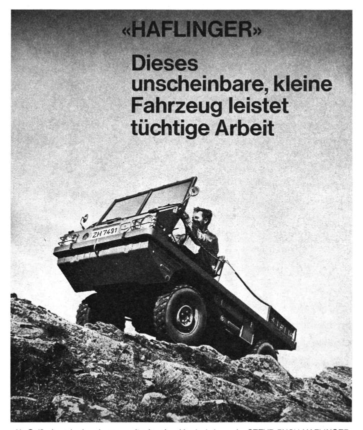
Als Gelände- oder Landwagen, mit oder ohne Verdeck, kann der STEYR-PUCH-HAFLINGER praktisch überall eingesetzt werden: Beim Bau, in der Landwirtschaft, als Feuerwehrwagen, zum Schneeräumen, zum Schleppen etc. Die Steigfähigkeit beträgt 65%, der Kippwinkel 45°. Der HAFLINGER watet unerschrocken durch Wassergräben, erklimmt felsige Steilhänge oder klettert über gefällte Baumstämme. Dank seiner Bauchfreiheit sitzt er bei kurzen steilen Hindernissen nicht auf, noch fährt er sich fest.
