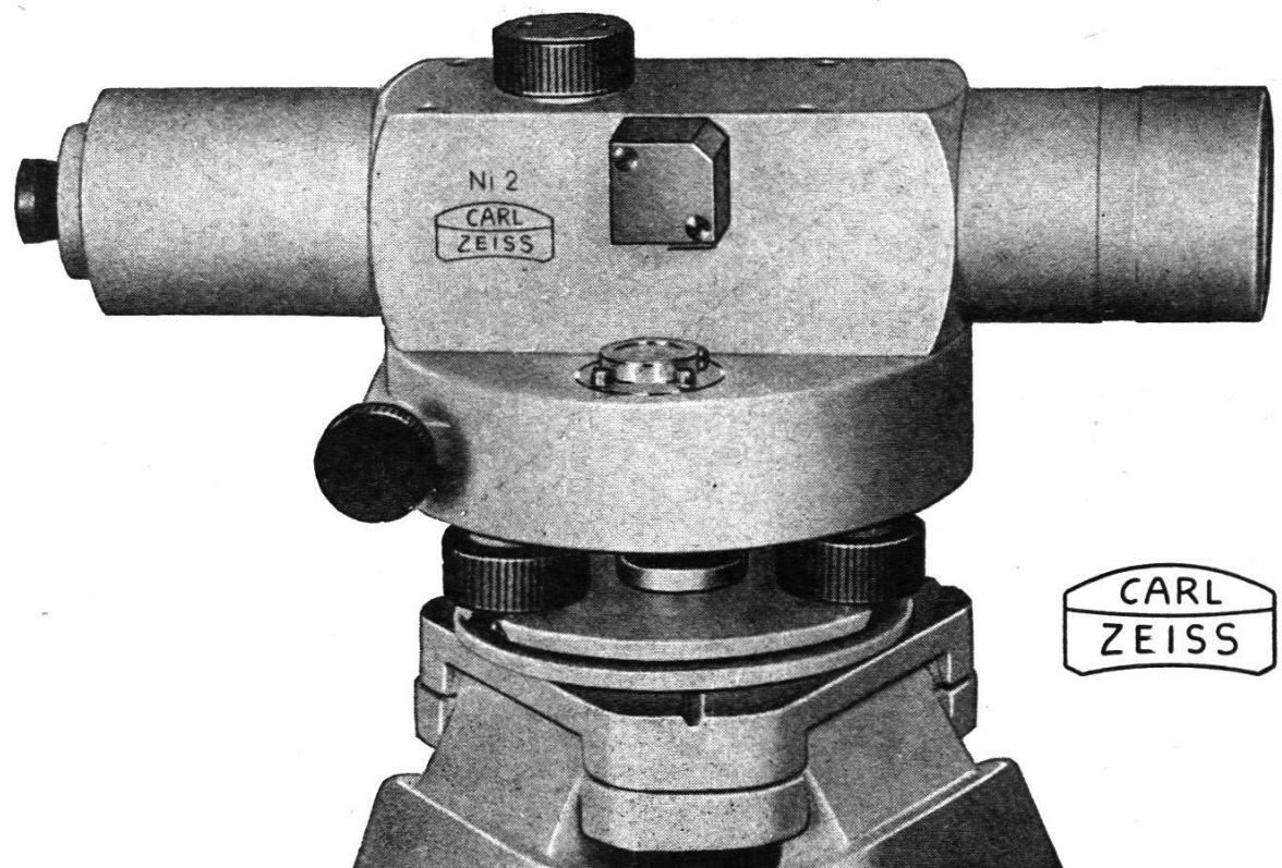
Optischer, selbsttätig horizontierender Kompensator = Arbeitstempo um bis zu 100% erhöht!
