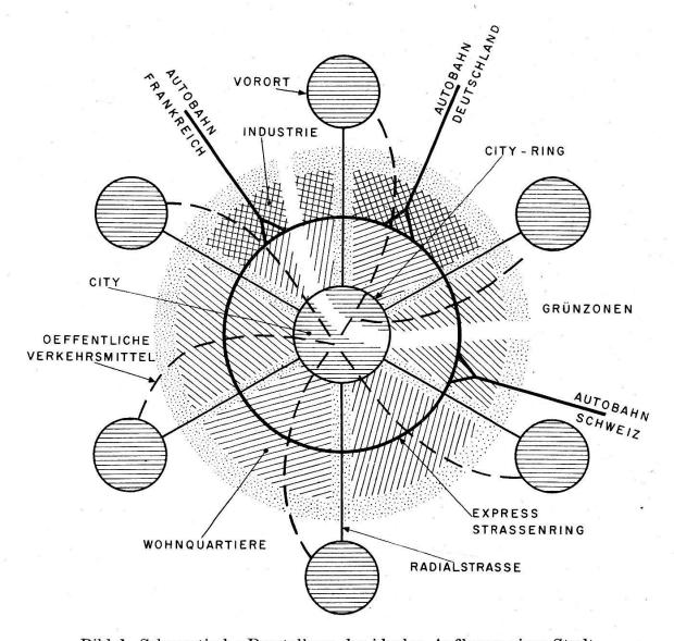
Bild 1. Schematische Darstellung des idealen Aufbaues einer Stadt
