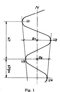
Beim Aufsatzkreisel GAK1 kann ein Umkehrpunkt auf  $\pm 25^{\circ\circ}$  erfaßt werden. Die Verwendung eines Minutentheodolits mit 0,1°-Schätzung genügt deshalb immer zur Erreichung der vom Aufsatzkreisel her möglichen Genauigkeit.
