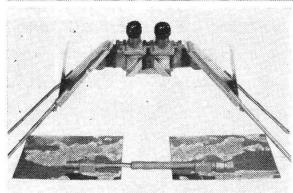
Spiegelstereoskop Wild ST4 mit Binokularaufsatz und Stereomikrometer
