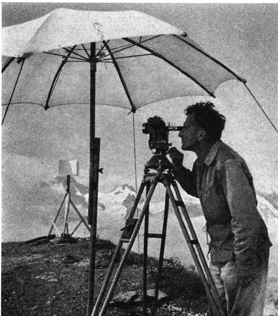
Präzisionstheodolit Wild T3 für Triangulationen höherer Ordnung
