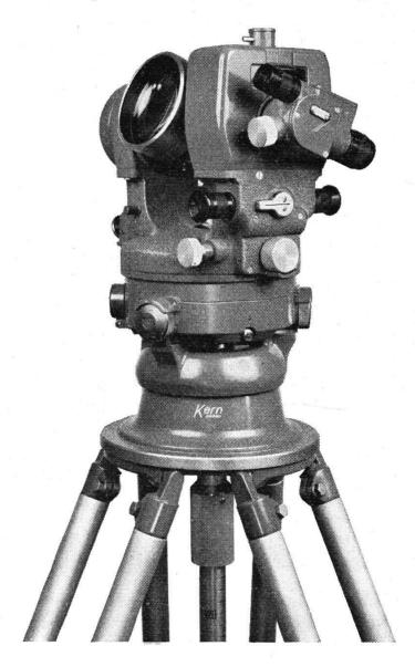
Großer Doppelkreis-Triangulationstheodolit von Wild, fabriziert von Kern-Aarau DKM3. Das leistungsfähige Spiegellinsenfernrohr ist dank einiger optischer Brechungen kurz gehalten. Spiegel- und Prismenanordnungen im Innern des Instrumentenkörpers vermitteln bequeme und leistungsfähige Mikroskop- und Mikrometerablesungen der Kreisteilungen
