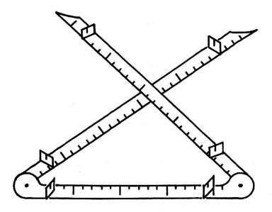
Triquetrum, Triangulations- und Trilaterationsgerät des Mittelalters, mit dem vermittels dreier Absehlineale die Netzdreiecke verjüngt reproduziert wurden
