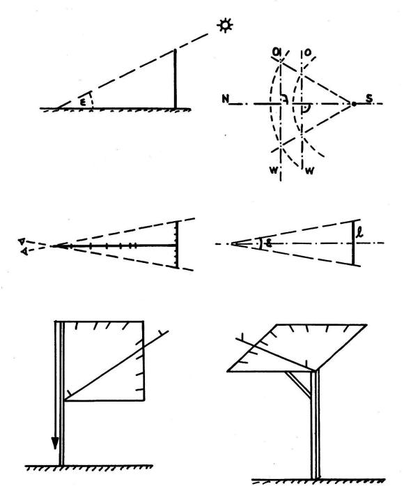
Geräte für die Winkel- und Richtungsmessung und indirekte Distanzmessung der Ägypter, Babylonier, Inder, Chinesen und Griechen: Schattenstab, Jakobsstab, Schattenquadrat
