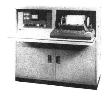
Universales stereoauswertegeraet hoechster genauigkeit analytischer stereokomparator universaler aerotriangulator
