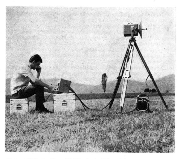
«Distomat DI 50» der Firma Wild-Heerbrugg: Elektronisches Distanzmeßgerät für Meßbereiche von 100 m bis 50 km, mit dem über die Laufzeit und damit über den Laufweg elektromagnetischer Wellen Distanzen gemessen werden
