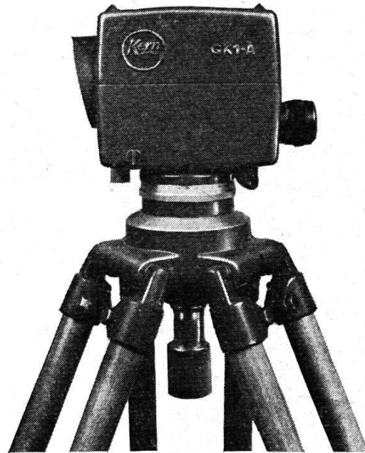
Modernes automatisches Nivellierinstrument Kern GK 1-A: die Fernrohrabsehgerade wird durch ein als Lot steuernd wirkendes Spiegelprismensystem in den Horizont gebracht. Entsprechendes Instrument von Wild-Heerbrugg NA 2
