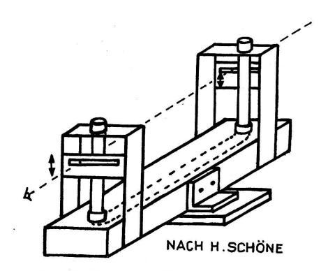
Erste Nivelliergeräte mit Flüssigkeitshorizont: oben: Dioptra von Heron (Kanalwaage), 150 v. Chr. unten: Chorobates von Vitruv (Wassercuvette im Richtscheit), 15 v. Chr.
