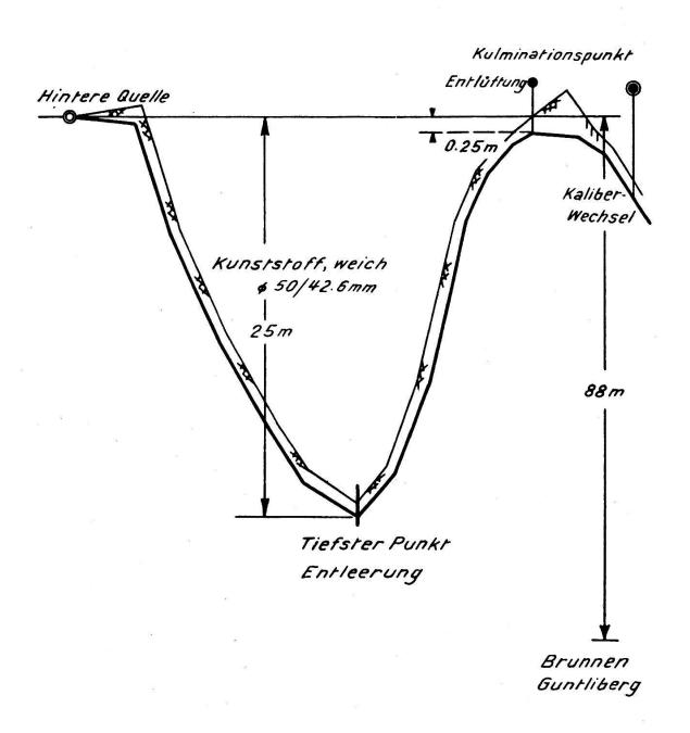
Leitung zuerst rund 25 m tiefer eine Geröllhalde hinab und dann jenseits wieder hinauf. So konnte das Felsband umgangen werden. Die relativ kleine Durchflußmenge ermöglichte es, das Kaliber auf dieser Strecke so zu wählen, daß der Reibungsverlust praktisch gleich Null ist.
