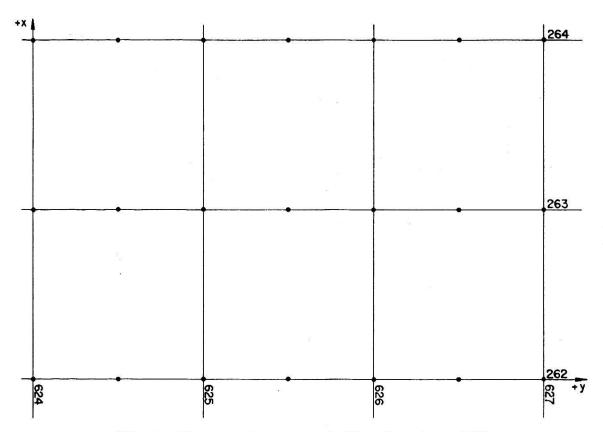
Abb. 2. Kilometergitternetz mit Einpaßpunkten (EP)
