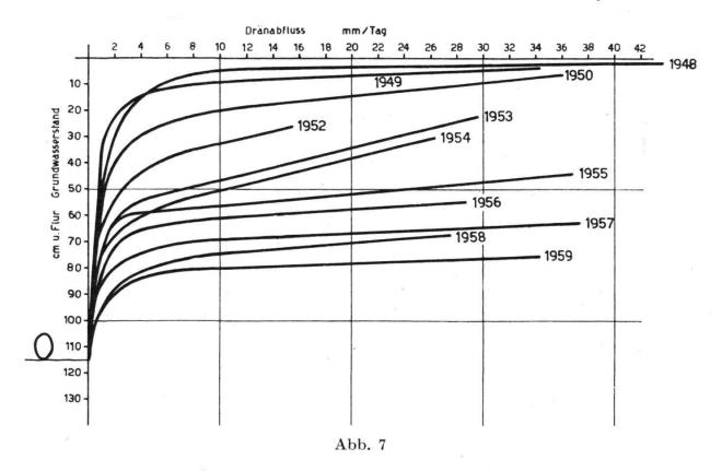
sind die Aufwölbung in Dränbeetmitte und der Durchlässigkeitsbeiwert des Bodens enthalten, mit deren Hilfe der jeweils erforderliche Dränabstand unter Berücksichtigung der täglich abzuführenden Wassermenge berechnet werden kann. In vorliegendem Fall ist die Aufwölbung in Dränbeetmitte, der tägliche Abfluß und der Dränabfluß bekannt. Deshalb ist es mit der Hooghoudtschen Formel möglich, die Durchlässigkeit des Bodens aus diesen bestimmten Daten zu errechnen.
