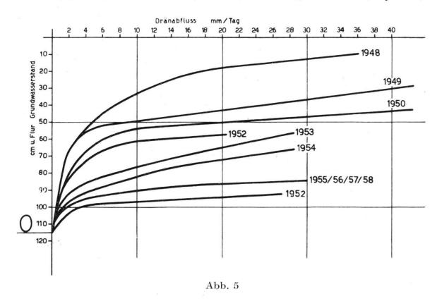
Dranabfluss - Grundwasserstand (Beetmitte), 1948 bis 1959. System 2.
