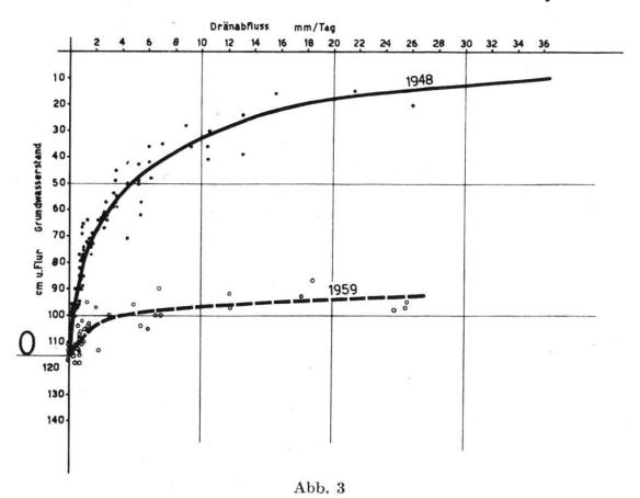
Dränabfluss - Grundwasserstand (Beetmitte), 1948 und 1959 System 3.
