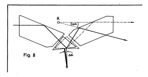
Der Aufbau des Kompensators des NA 2
