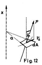
2. Das Moment  $M_{D_2}$  infolge der Einwirkung einer äußeren Kraft (Blattfederkraft beim NA2) auf die Längsfasern des tordierten Drillfadens [12, p. 9].
