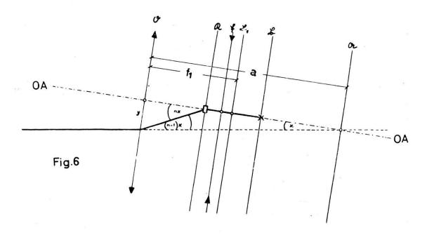
Ist der Faktor n=2, so ist der bildseitige Brennpunkt des feststehenden Objektivteiles der Kippungspunkt. Will man einen gestreckten Fernrohraufbau wie beim Libellennivellier beibehalten, so soll n klein sein. Bei den oben angeführten Instrumenten ist der Strahlengang mehrfach geknickt.
