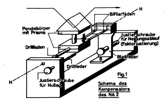
fäden werden aus ihrer ursprünglich ebenen Ausgangslage zueinander windschief. Dadurch verringert sich der Abstand zwischen den Einspannstellen am Pendel und an der Blattfeder. Die beiden äußeren Einspannstellen EE versetzen sich infolge Nachgebens der Blattfeder gleichmäßig in Richtung zum Pendelkörper. Diese Versetzung wird entsprechend der Größe der Kippung verschieden groß sein.
