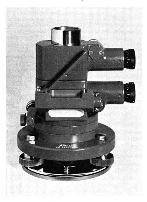
Optisches Präzisionslot Kern für gleichzeitige Auf- und Ablotung
