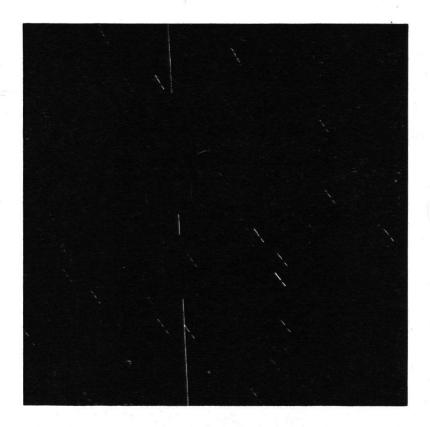
Fig. 3. Mit Wild BC-4-Kamera aufgenommene Spur des amerikanischen Ballonsatelliten «Echo» I. Die Hintergrundsterne auf diesem zentralen Ausschnitt der Platte (etwa 13 × 13°) gehören zum Sternbild Herkules. Aus den unsymmetrischen Unterbrechungen ist ersichtlich, daß sich der Satellit etwa 100mal schneller und in umgekehrter Richtung als die Sterne bewegt hat
