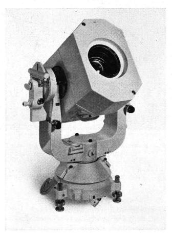
Fig. 2. Die von Wild Heerbrugg entwickelte ballistische Kamera BC-4, die vom U.S. Coast and Geodetic Survey zur Aufnahme von Satelliten für geodätische Messungen verwendet wird
