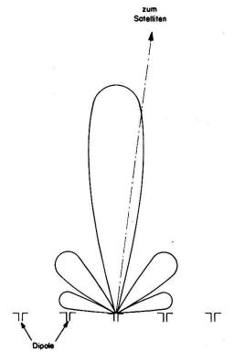
Fig. 5. Radioelektrische Richtungsbestimmung. Einzelne Antennen, auf einer längeren Strecke aneinandergereiht, bilden ein Analogon zum optischen Gitter. Durch die Interferenzen entsteht eine stark richtungsabhängige Empfangsintensität. Die Maxima sind um so schärfer, je größer das Verhältnis der Gesamtlänge der Antenne zur Wellenlänge der Radiowellen ist.
