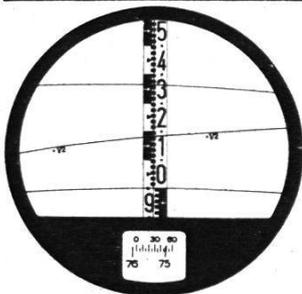
Das Bild im Fernrohr ist höhen- und seitenrichtig. Man sieht gleichzeitig das Lattenbild, die Distanz- und die Höhenlinie sowie den Höhenkreis.
