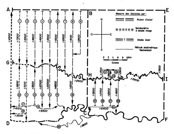
Fig. 3. Réseau de polygonation avec les erreurs de fermeture en relation des longueurs
