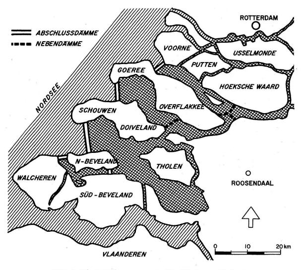
Bild 3. Die Deltabauten an der Westküste von Holland. (Einfache Schraffur = Meerwasser, doppelte Schraffur = Süßwasser)
