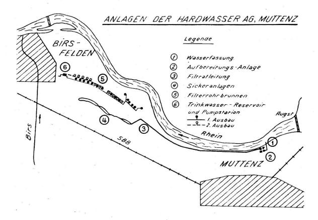
turm. Während die Entnahmemöglichkeit bei den Normalbrunnen rund 80 l/Sek. beträgt, beläuft sie sich bei den drei Brunnen mit horizontaler Fassung auf je rund 200 l/Sek. Die Gefahr der Sandförderung wird durch Begrenzung der Wasserentnahme klein gehalten.
