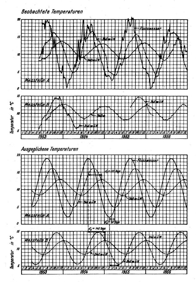
Abb. 4. Kontinuierliche Messung der Flußwasser- und Grundwassertemperaturen
