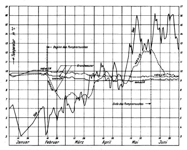
Abb. 5. Variation der Grundwassertemperatur in einer Bohrung, welche unmittelbar am Flußufer gelegen ist, während eines Pumpversuches. Nur der oberste Temperaturfühler (448 m ü. M.) zeigt eine Beeinflussung durch die verstärkte Infiltration von Flußwasser
