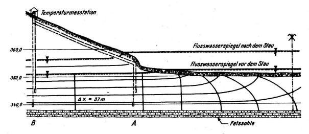
Abb. 3. Anordnung der Temperaturfühler im Grundwasserträger und Übersicht über die hydrologischen Verhältnisse vor und nach dem Stau
