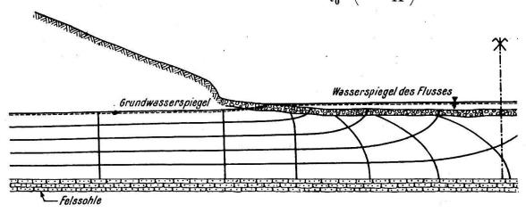
Abb. 2. Speisung des Grundwassers durch Flußwasserinfiltration
