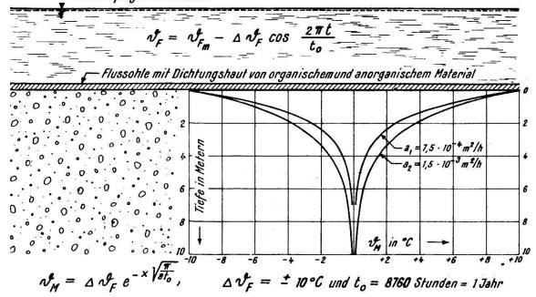
Abb. 1. Variation der Grundwassertemperatur bei ruhendem Grundwasser infolge der Variation der Flußwassertemperatur bei Wärmeübertragung durch Wärmeleitung
