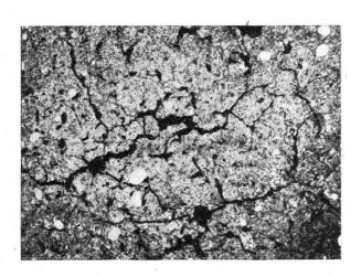
Bild 3. Struktur nach 4 Jahren, 50 cm vom Molegang entfernt
