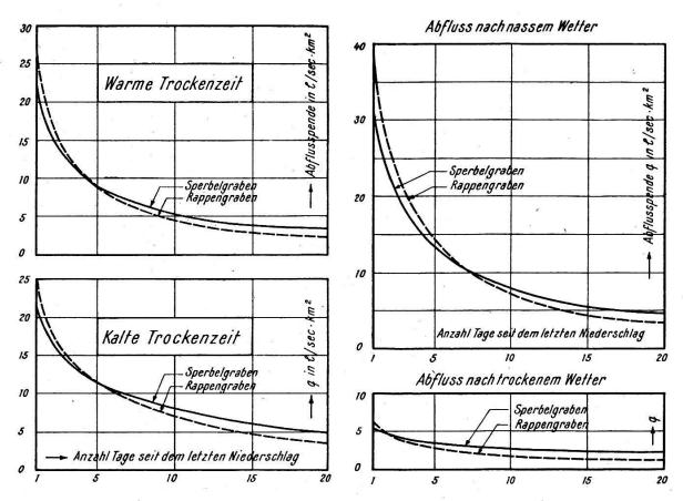
Abb. 7. Abnahme des Abflusses im Sperbel- und Rappengraben bei warmen und kalten Trockenzeiten und ungefähr gleichem Anfangsabfluß
