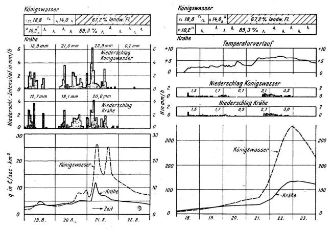
Abb. 5. Niederschlag und Abfluß von Königswasser und Krähe im Ruhrgebiet bei mehrtägigen Sommerniederschlägen (19. bis 22. August 1952)
