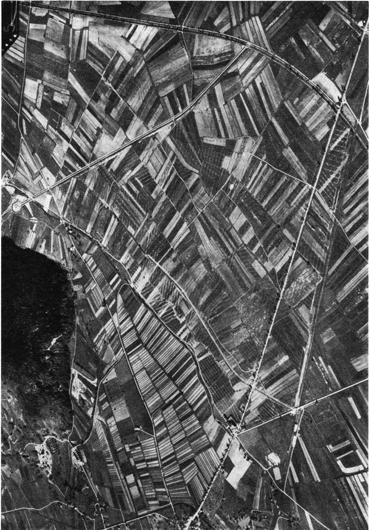
Abb. 3. Drainagegebiet Annam. Deutlich ist der hohe Parzellierungsgrad sowie die Leistungen der verlegten Detailentwässerungen erkennbar
