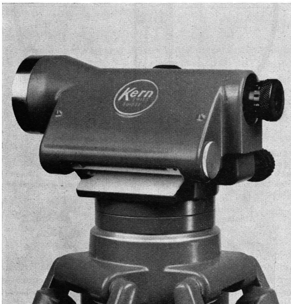
Abb. 1. Kern-Ingenieur-Nivellier GK 23 auf Gelenkkopfstativ
