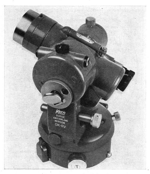
Abb. 1. Kern-Reduktionstachymeter DK-RV auf Zentrierstativ
