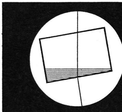
Verblüffend einfache Lösung der Automatik: Flüssigkeitsprisma ohne mechanische Teile, ohne Abnutzung, ohne Störungen, ohne Reparaturen.
