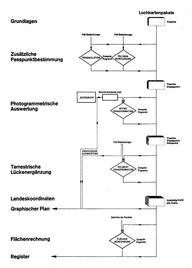
Abb. 1. Blockdiagramm des Datenverarbeitungssystems
