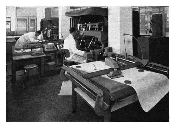
Abb. 2. Autograph Wild A 7 mit automatischer Datenregistrierung. Links vom Operateur Steuerpult, Schreibmaschine und Kartenlocher; rechts vom Zeichentisch der Relaisschrank
