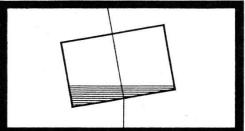
Der Strahlengang des Höhenkreis-Mikroskopes wird beim Wild T1-A durch ein Flüssigkeitsprisma geleitet und derart gebrochen, dass bei waagrechter Sicht auch wirklich «1009» abgelesen wird.
