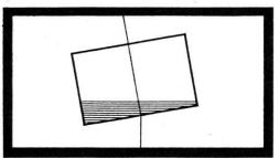
Der Strahlengang des Höhenkreis-Mikroskopes wird beim Wild T1-A durch ein Flüssigkeitsprisma geleitet und derart gebrochen, dass bei waagrechter Sicht auch wirklich «1009» abgelesen wird.
