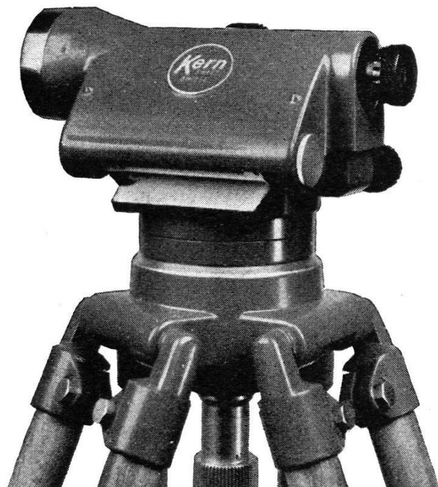
Kern GK 23, das Mehrzweck-Ingenieur-Nivelier mit den entscheidenden Vorteilen: schnellste Messbereitschaft dank dem Kern Kugelgelenkkopf, Beobachtung der Fernrohrlibelle durch das Fernrohrkular, Fokussierung mit Grob-Fein-Trieb, Seitenfeinstellschraube mit Rutschkupplung
